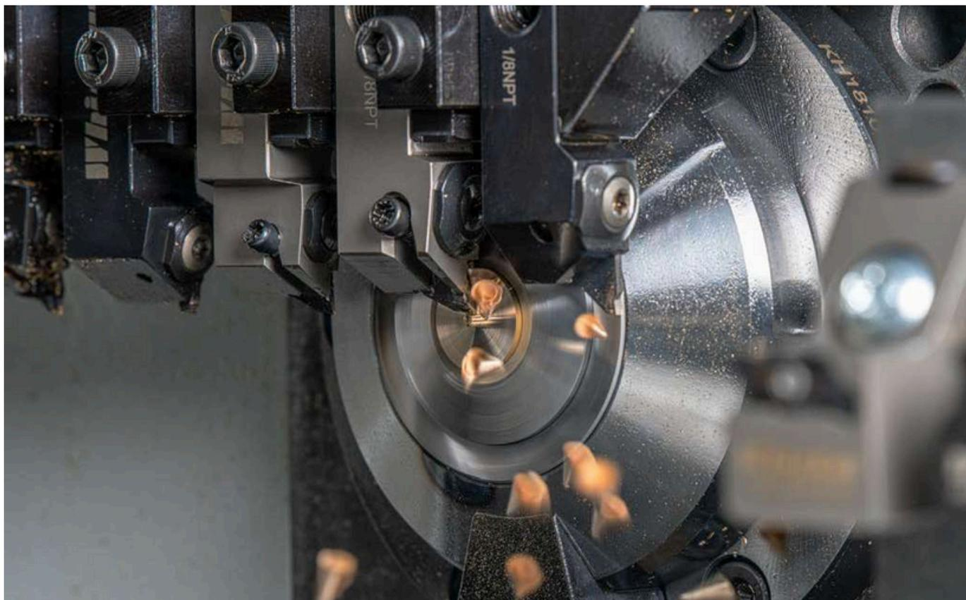
*WhizCut Signatur-Produktreihe ermöglicht Drehen mit hoher Schnitttiefe, bis zu 8 mm. Dadurch wird eine hervorragende Spankontrolle und eine ausgezeichnete Oberflächenbeschaffenheit erzielt.*
